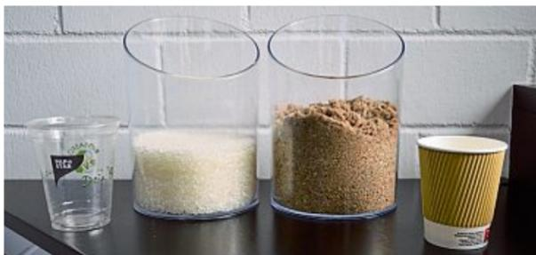
Der Becher aus Maisstärke (l.) wird zu Granulat recycelt, der Pappbecher zu einem faserhaltigen Stoff.
